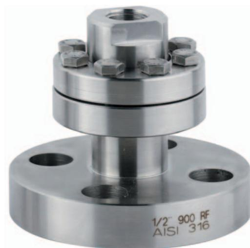
Realizzati per isolare l' elemento sensibile di manometri, pressostati, trasmettitori elettronici di pressione da fluidi di processo corrosivi, viscosi, sedimentosi e ad alta temperatura e pressione. Una membrana elastica serrata meccanicamente e sottoposta a prova di tenuta garantisce la separazione del fluido di trasmissione da quello di processo. La tenuta metallica della membrana garantisce l' utilizzo del separatore ad alte temperature eliminando i problemi delle guarnizioni.
